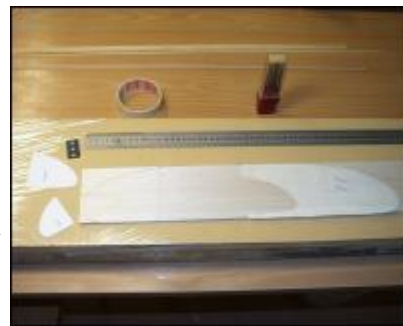
Med pappersmallen ritas hela vingen ut på balsaflaket.
